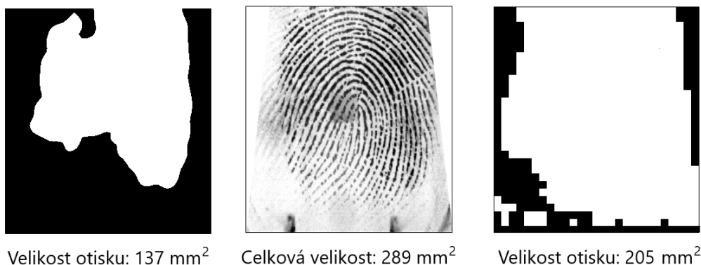
Obrázek 5.7: Původní obraz a masky při zpracování podle pixelů (vlevo) a podle bloků (vpravo).
