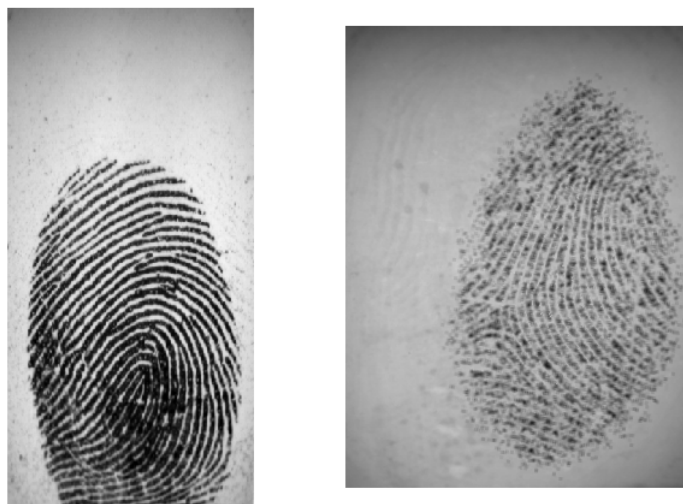
Obrázek 2.7: Otisky poškozené okolním osvětlením.
