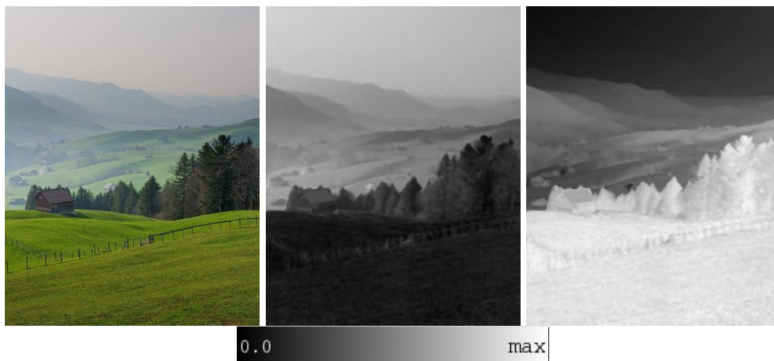
Obrázek 5.2: Vlevo: vstupní obrázek, uprostřed: tmavý kanál (dark channel) obrazu, vpravo: výsledná mapa t získaná metodou dark channel
