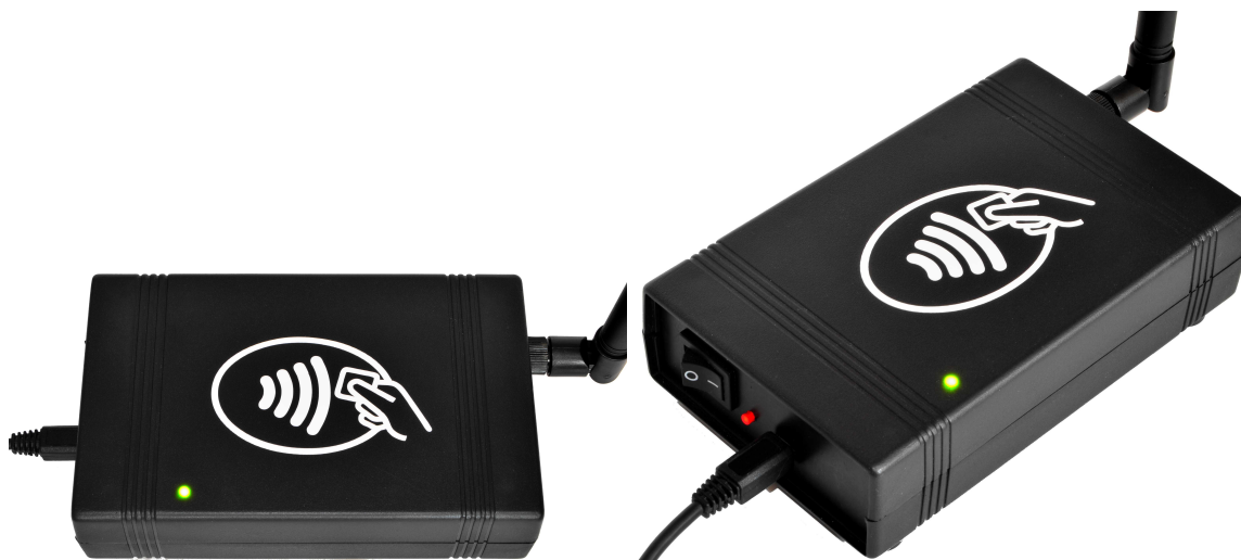
Obr. 10.1: Konštrukcia výsledného prototypu so spusteným záložným napájaním.
