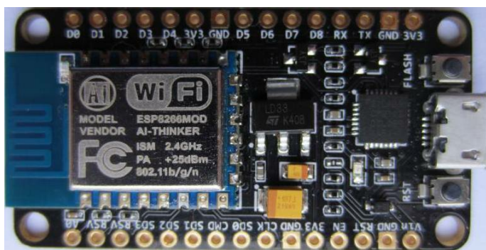
Obr. 3.6: Vývojový modul Node MCU Devkit 1.0 s osadeným čipom ESP8266 [2].
