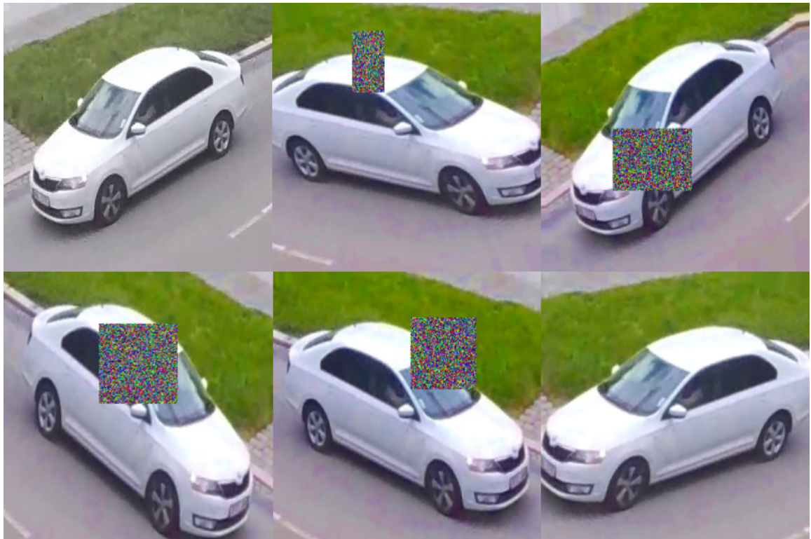
Obrázek 4.8: Ukázka fungování vybraných data augmentation metod. Obrázek vlevo nahoře je originální, ostatní jsou z něj vytvořeny náhodnými úpravami.
