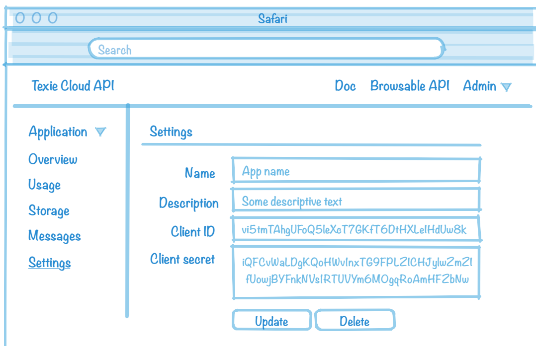
Obrázek D.5: Drátěný model zobrazující koncepční návrh rozhraní obrazovky Settings . Obsahová část umožňuje uživateli zobrazit informace o aktuálně aktivní aplikaci, případně ji dovoluje editovat nebo trvale odstranit.
