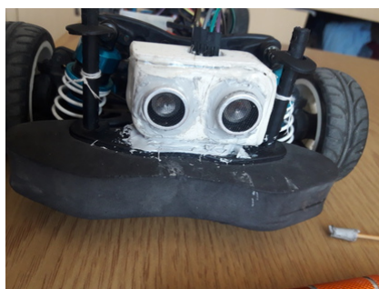
Obrázek A.12: Připevněné senzory vpředu a vzadu na modelu
