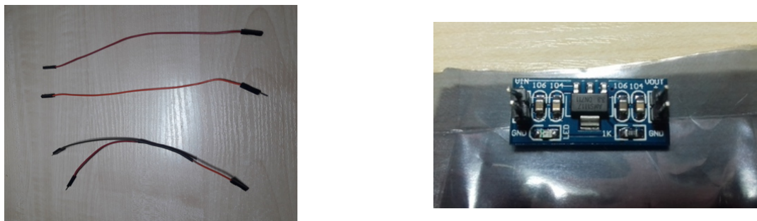
Obrázek 5.3: Na levém obrázku lze vidět typy propojů, na pravém je stabilizátor napětí AMS1117.
