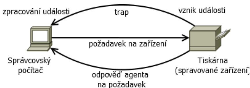
Obrázek 3.1: Vztah mezi správcovským zařízením (NMS) a spravovaným zařízením (tiskárna).
