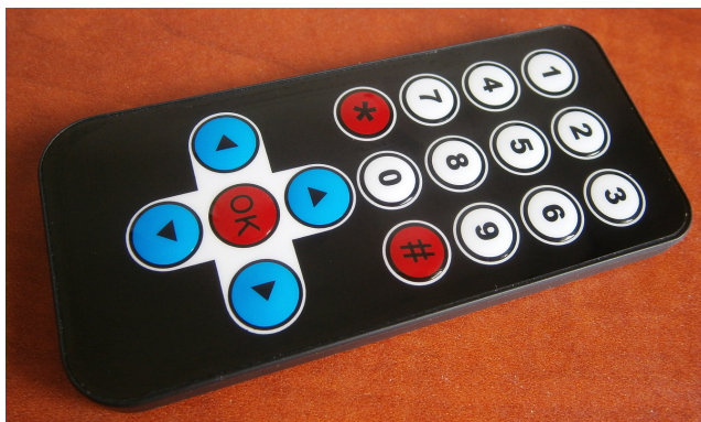
Obrázek 4.5: Dálkový ovladač IR a teploměr DS18B20 .
