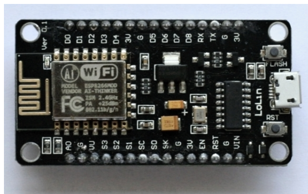
Obrázek 3.1: Fotografie modulu NodeMCU obsahující ESP-12E
