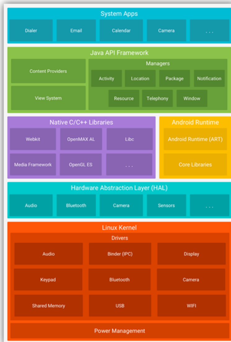
Obrázek 5.2: Diagram architektury operačního systému Android, ukazující pět základních [5].
