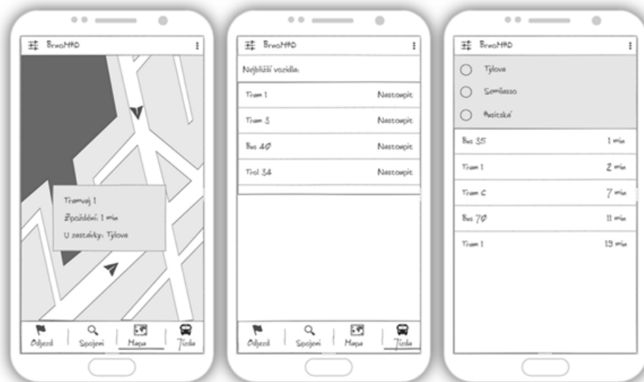
Obrázek 7.9: Návrh obrazovek. Vlevo obrazovka s mapou a polohou vozidel. Uprostřed obrazovka s nejbližšími vozidly s možností nastoupení. Vpravo obrazovka pro režim jízdy se sledováním trasy a možnými přestupy.
