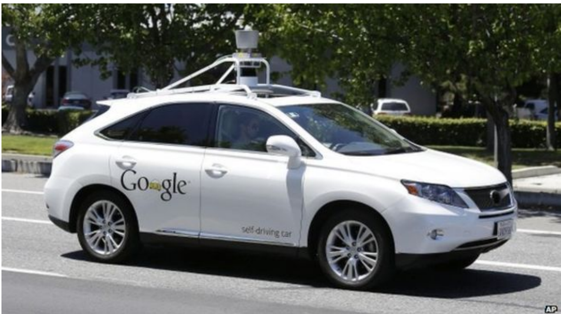
Obr. 2.10: Auto spoločnosti Google s LiDAR senzorm
