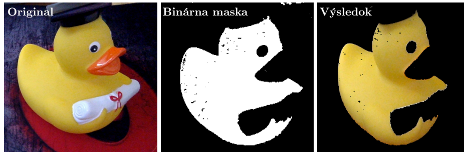
Obr. 2.5: Detekcia tela kačky na základe prahovania. Demo program príloha E.
