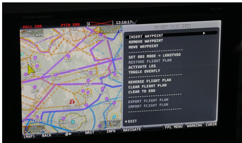
Obrázek 2.6: Pohled na obrazovku Dynon D100 zobrazující mapu s otevřeným menu pro zadání letové trasy. Fotka byla pořízena na letišti v Kotvrdovicích.
