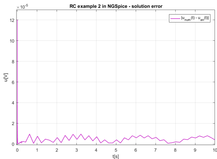
Obr. 3.35: Absolútna chyba numerického a analytického riešenia RC obvodu, ktorého schéma je na obrázku 3.24 vpravo, so striedavým zdrojom napätia, odsimulovaného v nástroji NGSpice.
