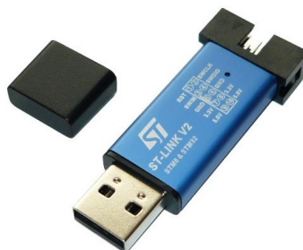
Obrázek 3.4: ST link programátor použitý při programování desky. 4
