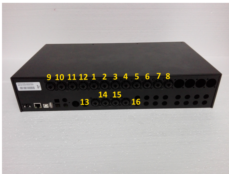
Obrázek 6.3: Na obrázku lze vidět označení slotů, do kterých se připojují mikrofony na ARM sestavě. Lze vidět, že čísla nejsou seřazena a bylo potřeba experimentálně zjistit, které sloty jsou označeny pod kterými čísly.
