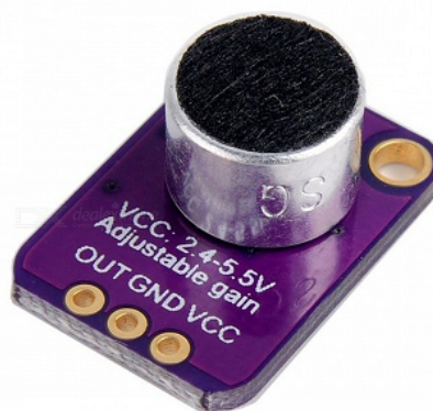
Obrázek 3.2: Na obrázku lze vidět použitý mikrofon. Jedná se o analogový mikrofon s nastavitelnou hodnotou gain. 2
