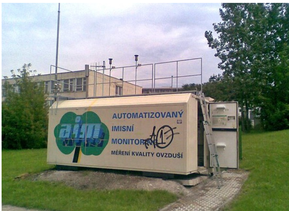
Obrázek 2.1: Měřicí stanice automatizovaného imisního monitoringu v Teplicích.[44]
