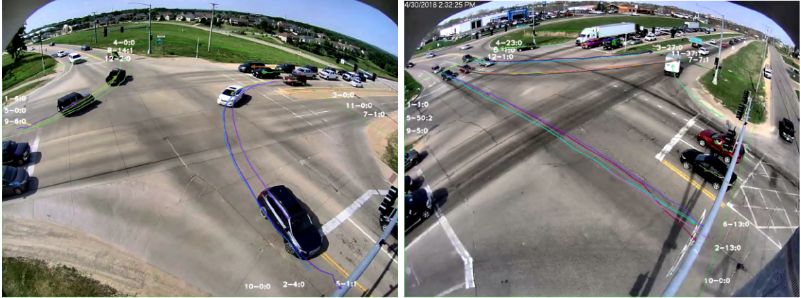
Obr. 4.2: Na obrázku sú zobrazené príklady výstupu systému, na ktorých sú rozdielnymi farbami vykreslené trajektórie vozidiel, vrátane počítadiel vozidiel v jednotlivých smeroch.
