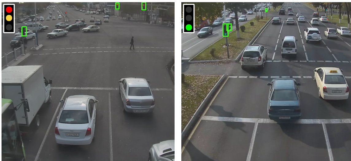
Obrázek 5.2: Eliminace chybně detekovaného semaforu využitím ostatních detekcí.
