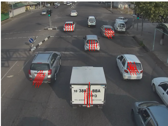
(a) Využití optického toku pro měření pohybu vozidel v obraze.
