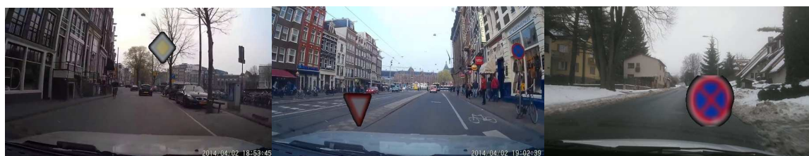
Obrázek 4.4: Na tomto obrázku je znázorněna deformace dopravního značení s použitím tzv. blur filtru. V podstatě jde o rozmazání značky, které má simulovat detekci za vysoké rychlosti či při prudkých změnách směru. Rozmazání ve snímaném obraze vzniká technickými omezeními kamery ve vozidle.
