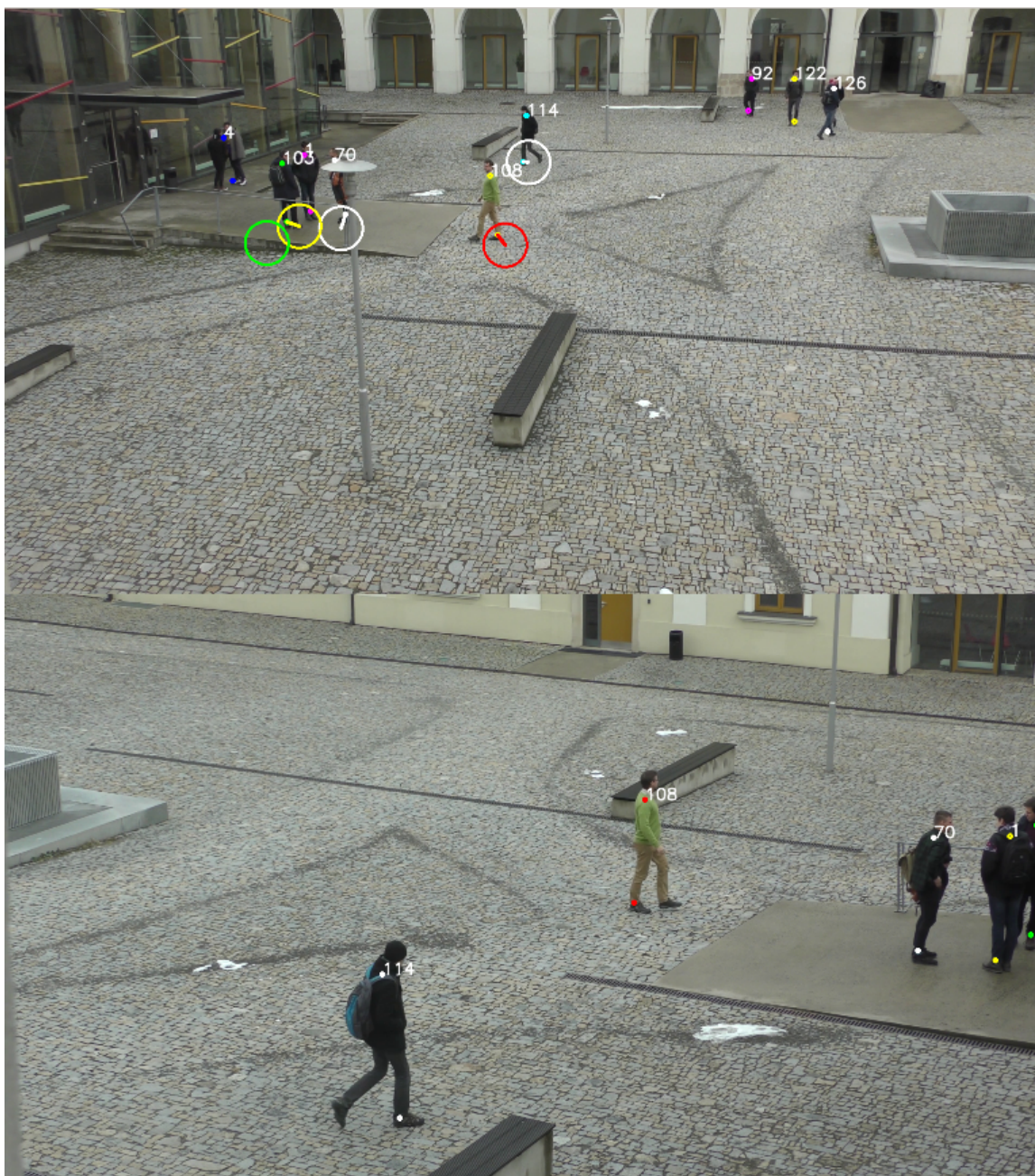
Obrázek 3.9: Vizualizace párování identit mezi kamerami. Na dolní detailní kameře jsou lidé s přiděleným id a detekovaným statickým bodem u země. Tento bod je homografií přenesen na horní přehledovou kameru a znázorněn stejně barevným kroužkem. V okolí přeneseného bodu se vyhledává nejbližší člověk. Párování probíhá na základě takto spárovaných bodů.
