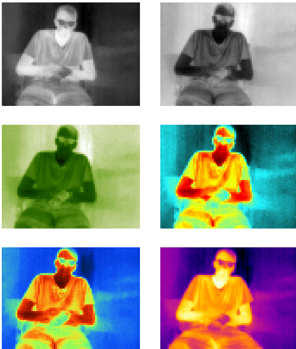
Obr. 5.4: Vygenerované palety farieb pre termogram.
