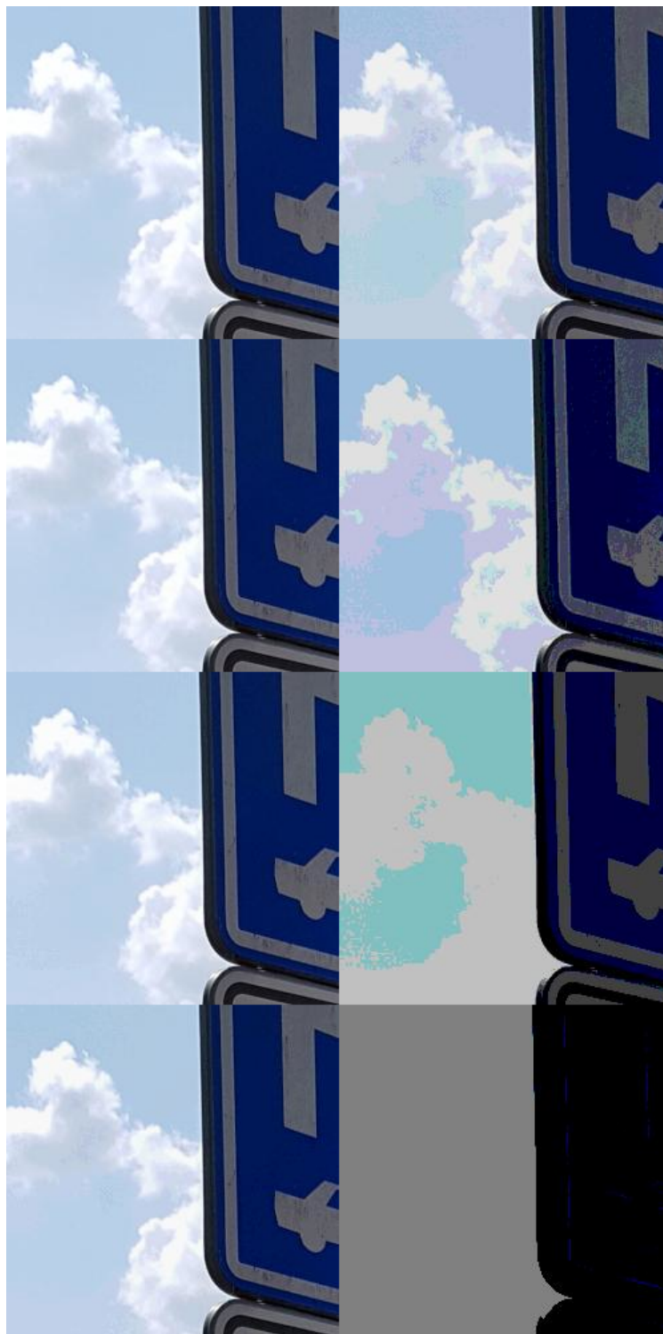
Obrázek 3.5: Nulování posledních bitů, kde vlevo nahoře je zobrazen originál a postupně jsou nulováno více bitů, obrázky jsou seřazeny v prvním sloupci směrem dolů a pokračují v druhém sloupci dolů a poslední vpravo dole je obrázek s nenulovaným pouze 8. bitem každé barvy.
