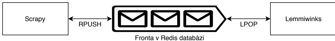
Obrázek 5.2: Fronta po výměnu dat mezi procesy.
