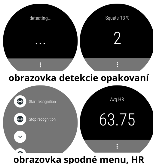
Obr. 6.3: Ukážka reálnych snímok z behu aplikácie. Prvý riadok zobrazuje funkcionality detekciu opakovaní, zľava: upozornenie užívateľa na započatú detekciu a bežiacu inferenciu nasledované informáciou o úspešne rozpoznanom opakovaní s informáciou o stupni istoty z poslednej inferencie (nie posledného úspešného rozpoznaní). Druhý riadok ukazuje menu dostupné potiahnutím zo spod displeja umožňujúce začatie a ukončenie detekcie a tiež obrazovku informujúcu o priemernom srdečnom tepe od počiatku aktuálnej detekcie.
