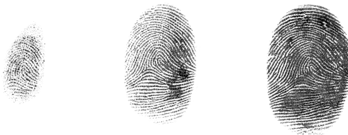
Obrázek 5.2: Otisk prstu podle tlaku vyvinutý na čtečku (zleva: nízký, normální a velký).
