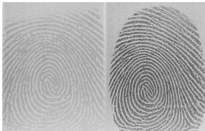
Obrázek 5.3: Test kapacitního senzoru. Vlevo otisk sejmutý z razítka, vpravo ze živého prstu.
