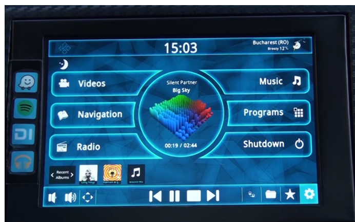
Obrázek 2.4: Vestavěný palubní počítač automobilu založený na ODROID C2 s operačním systémem Kodi (Android) [5].
