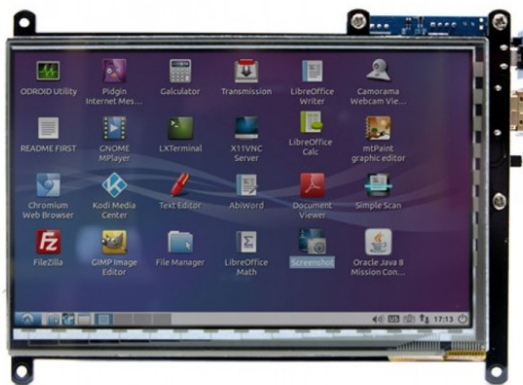
Obrázek 2.3: Dotykový panel (ODROID-VU7) o úhlopříčce 7 palců. Na displeji je prostředí Arch Linux [1].
