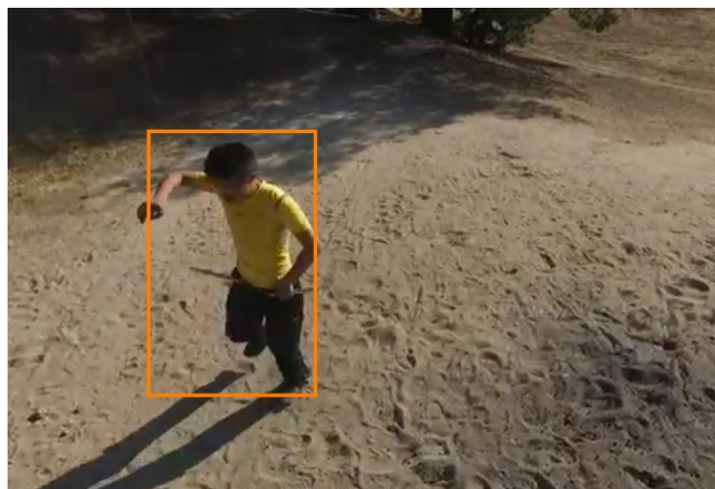
Obrázek 2.3: Příklad detekce objektu, objekt je ohraničený obdélníkem (bounding boxem) [15].
