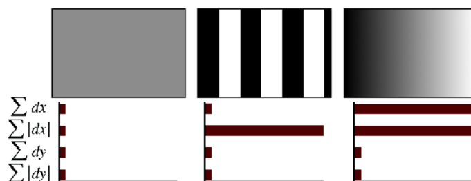
Obr. 2.25: Príklad hodnôt popisného vektora pre rôzne obrazy. Pre homogénny obraz sú všetky hodnoty relatívne nízke. Pri periodických hodnotách na osi x sa zvýši hodnota \sum |d_x| , ale všetky ostatné ostanú nízke. Ak sa hodnota na osi x postupne mení, tak sa okrem \sum |d_x| zvýši aj hodnota \sum d_x . Prevzaté z [13].
