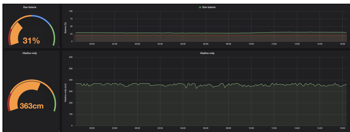
Obrázek 5.3: Ukázka nástroje Grafana. V horní části lze vidět ukazatel baterie. Hladinu vody lze vidět ve spodní části.
