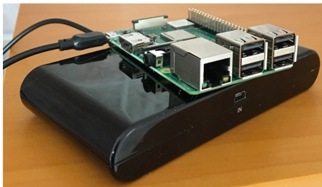
Obrázek 7.4: Raspberry Pi 3B+ napájené z powerbanky.
