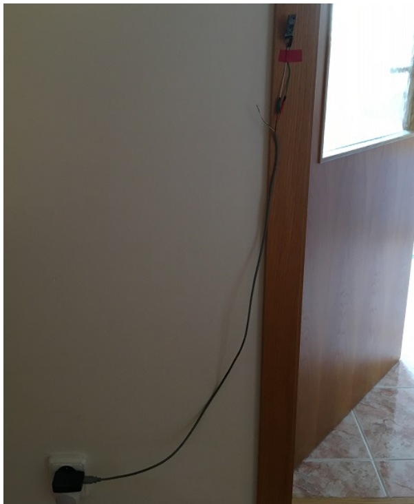
Obrázek 8.2: Zapojení vysílače do zásuvky a umístění na rám dveří.
