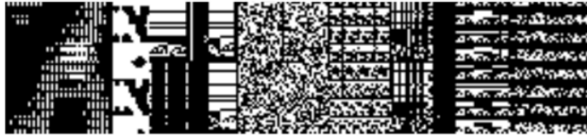
Obr. 3.2: Grafické znázornenie pamäte programu alebo binárnych dát, kde 0 je zobrazená ako čierna a 1 ako biela.
