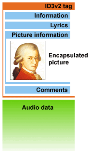
Obr. 3.1: Štruktúra tagu ID3v2. Prevzaté z [5].
