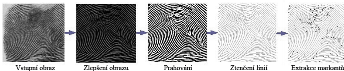
Obrázek 2.4: Schéma zpracování otisku prstu. Zdroj: [5]
