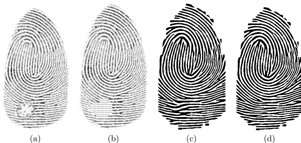
Obrázek 6.11: Ukázka odstranění bílých a černých skvrn. (a) Vstupní syntetický otisk prstu s bradavicí - bílou skvrnou. (b) Skvrna nahrazena generovaným pruhovým vzorem. (c) Rekonstruovaný otisk bez odstranění skvrn. (d) Rekonstruovaný otisk po odstranění skvrn.
