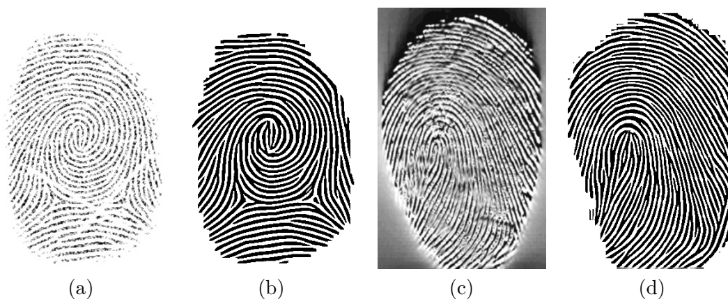
Obrázek 7.8: Ukázka vlivu míry poškození otisku prstu na výslednou míru změny struktury singulárních bodů. (a) Vstupní otisk vyšší kvality. (b) Zpracovaný otisk s téměř nepozměněnou strukturou singulárního bodu. (c) Vstupní otisk nižší kvality. (d) Zpracovaný otisk s vyšší mírou změny struktury singulárního bodu.
