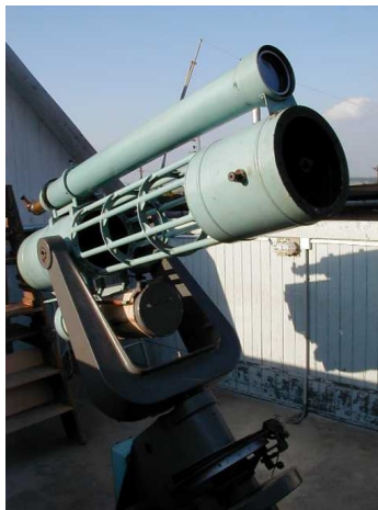
Obrázek 2.3: Vidlicová montáž dalekohledu městské hvězdárny ve Zlíně
