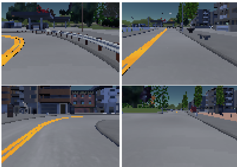
Obrázek 3.2: Snímky kamery o velikosti 100 \times 70 pixelů nasnímané kamerou vozidla v rámci simulátoru CARLA.
