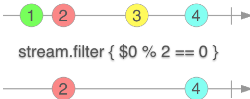
Obrázek 3.4: Aplikace operátoru Filter tak, aby prošly pouze sudé čísla celočíselného datového toku.
