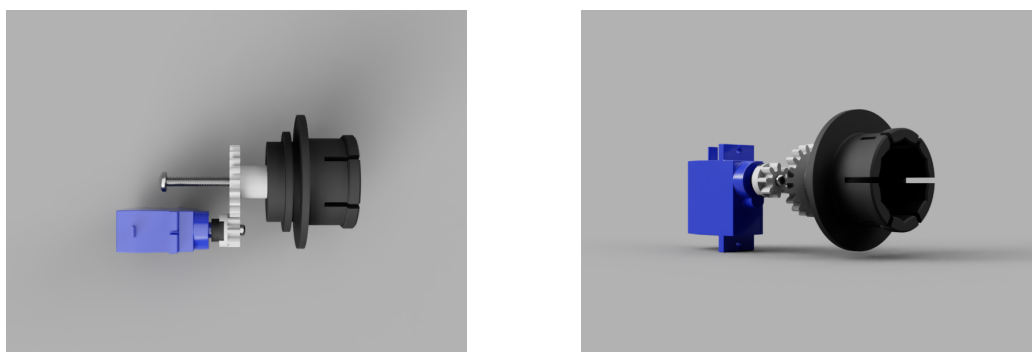
Obrázek 5.4: Mechanismus ovládání ventilu otopného tělesa
