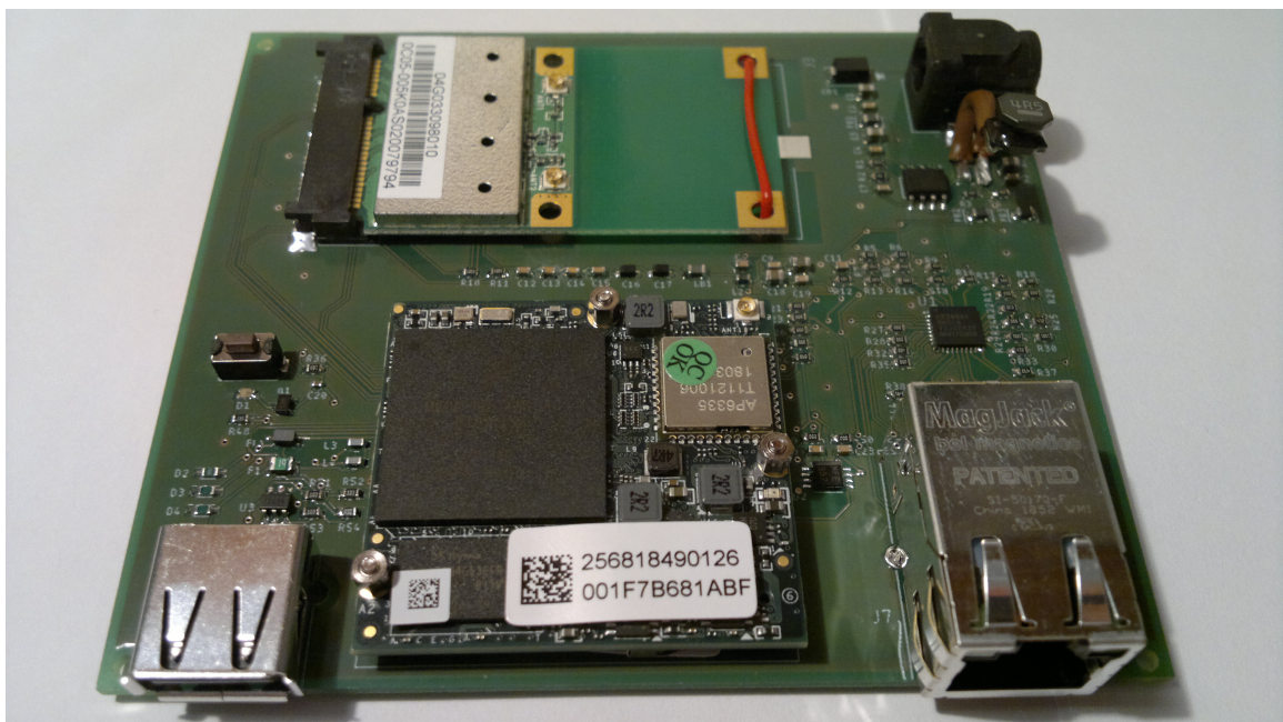
Obrázek C.2: Prototyp senzoru osazený CPU modulem i Wi-Fi.
