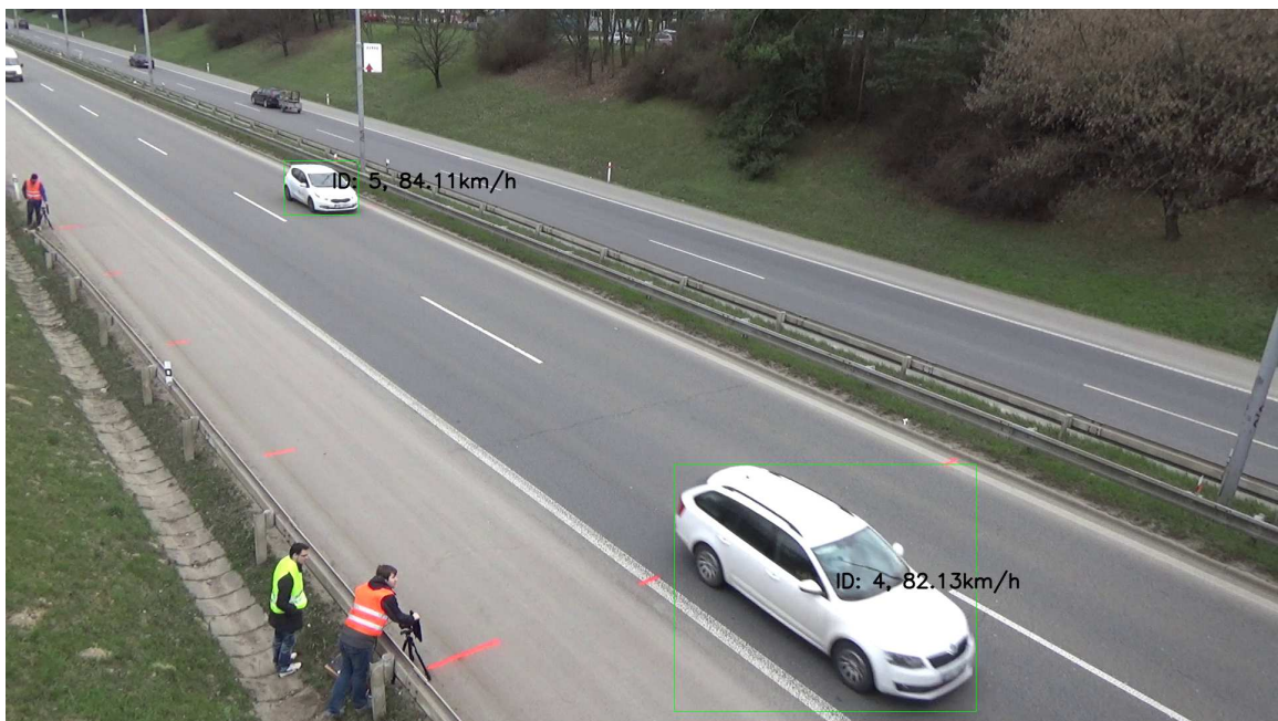
Obr. 4.8: Grafický výstup zobrazujúci ID a rýchlosť vozidiel.
