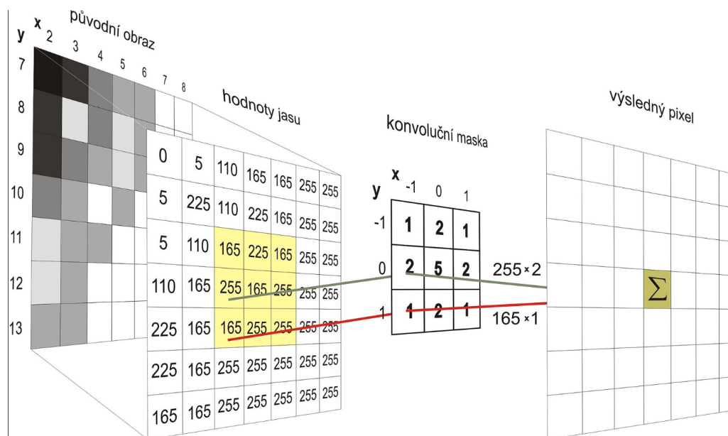
Obrázek 2.9: Grafická ukázka výpočtu konvoluce na černobílém obrázku. Původní obraz se reprezentuje do dvourozměrného pole v hodnotách 0-255, poté se přiloží konvoluční maska na vytvořené pole a vynásobíme každou hodnotu z konvoluční masky s hodnotou obrazu. Výsledek sečteme a získáváme tím výslednou hodnotu pixelu [28].
