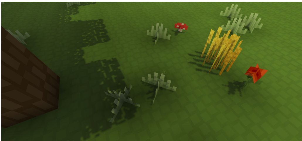
Obrázek 5.16: Stín vrhaný sluncem, rozlišení shadow mapy 2048^2 , aplikován percentage closer filtering
