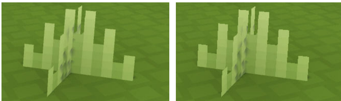
Obrázek 6.4: Aktivní (vlevo) a neaktivní (vpravo) multisample alpha testing
