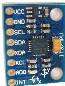
Obrázek 3.4: Modul *MPU-6050* [2, převzato].
