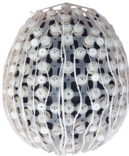
Obrázek 2.17: Více-elektrodový EEG snímač. Převzato a upraveno z webových stránek Compumedics 42 .
