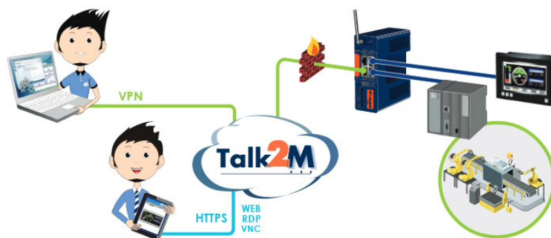
Obr. 2.8: Jednoduchý schématický popis bežne využívaného riešenia vzdialeného prístupu v priemysle.
