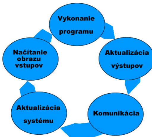
Obr. 2.3: Diagram zjednodušeného operačného cyklu PLC
