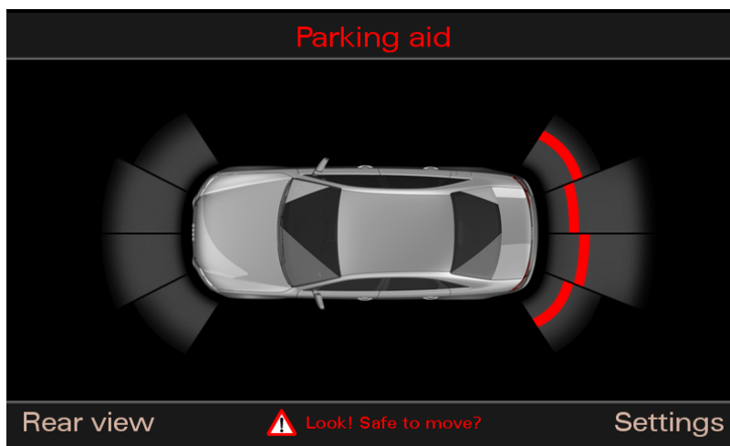
Obrázek 2.4: Grafické rozhraní parkovacího asistenta ve vozidlu značky AUDI, které využívá ultrazvukové vlny k detekci blízkých objektů 6
