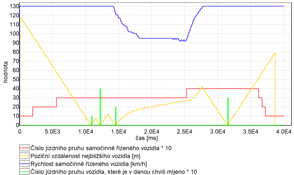
Obrázek 5.5: Graf, který ukazuje průjezd samočinně řízeného vozidla shlukem vozidel.
