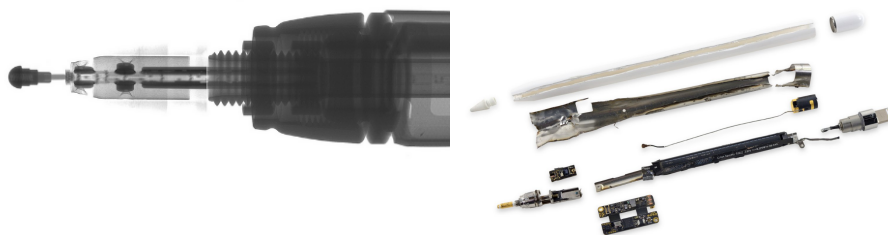
Obr. 2.10: Hrot z Apple Pencil (vľavo) a rozobratý stylus (vpravo) [12]
