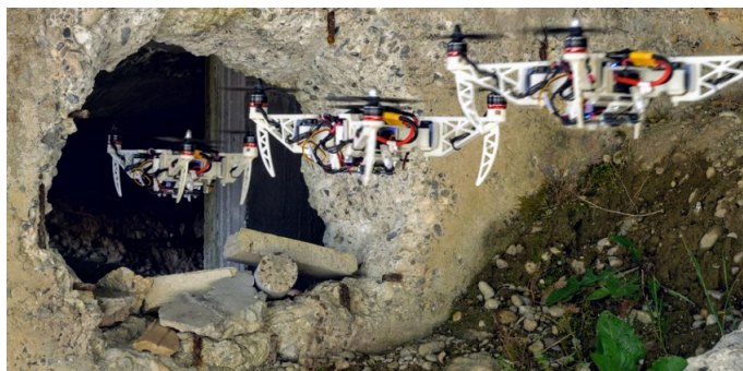
Obrázek 2.3: Příklad změny vzhledu objektu - skládací dron [18].
