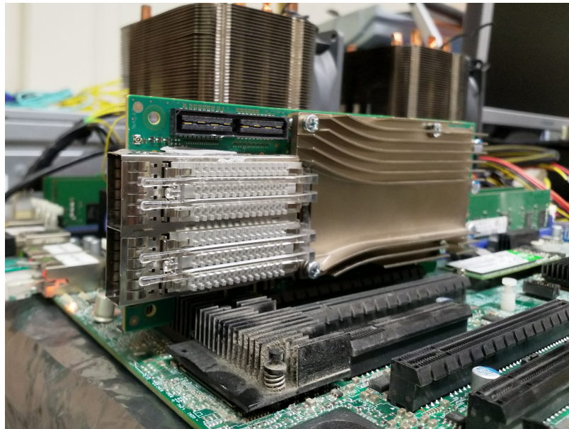
Obrázek 2.4: Karta COMBO-200q2ql s využitím jednoho PCIe portu
